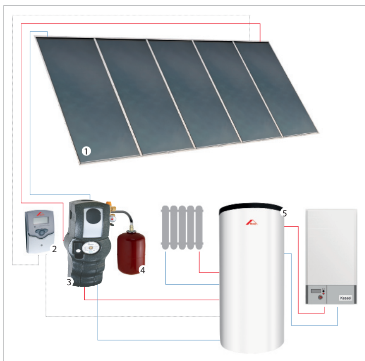
Pakiet systemowy CuboPur – komponenty do podgrzewania wody użytkowej oraz wspomaganie ogrzewania 1 Kolektor, 2 Regulator, 3 Stacja solarna, 4 Naczynie wzbiorcze, 5 Zasobnik CWU, (kocioł nie wchodzi w skład zestawu)
